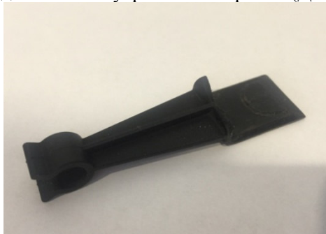
Рис. 1 – Разрушенный крепёжный элемент кронштейна
