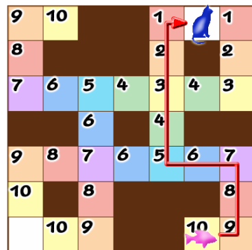
Рис. 3. Ситуация, когда по найденному мин. пути без разворотов робот приедет к станку не тем бортом.
