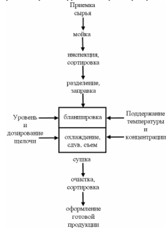
Рис. 1. Технологическая схема поточной линии по производству сухофруктов.
