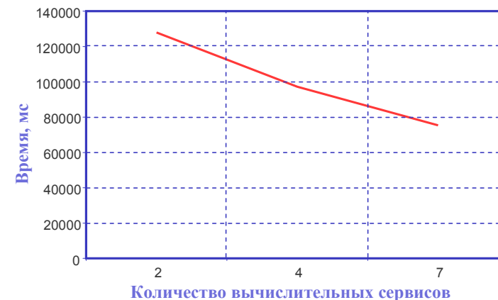
Рис. 3. Зависимость времени вычислений от количества вычислительных сервисов
